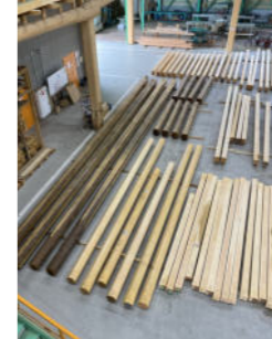
加工場に長さ12mの杉丸太を搬入。原寸模型を製作して確認。
