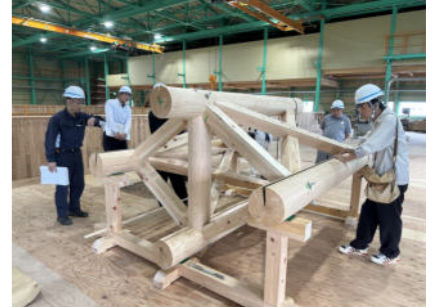
加工場に長さ12mの杉丸太を搬入。原寸模型を製作して確認。
